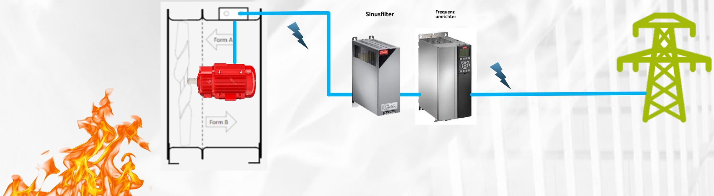
Nach EN 12101-3:2015 ist der Frequenzumrichterbetrieb eines Doppelmodus-Ventilators auch im Brandfall zulässig. Wenn aber Ventilator, Antriebsmotor und Frequenzumrichter **NICHT von Dritten geprüft und zertifiziert sind, ist Folgendes zu beachten:**
