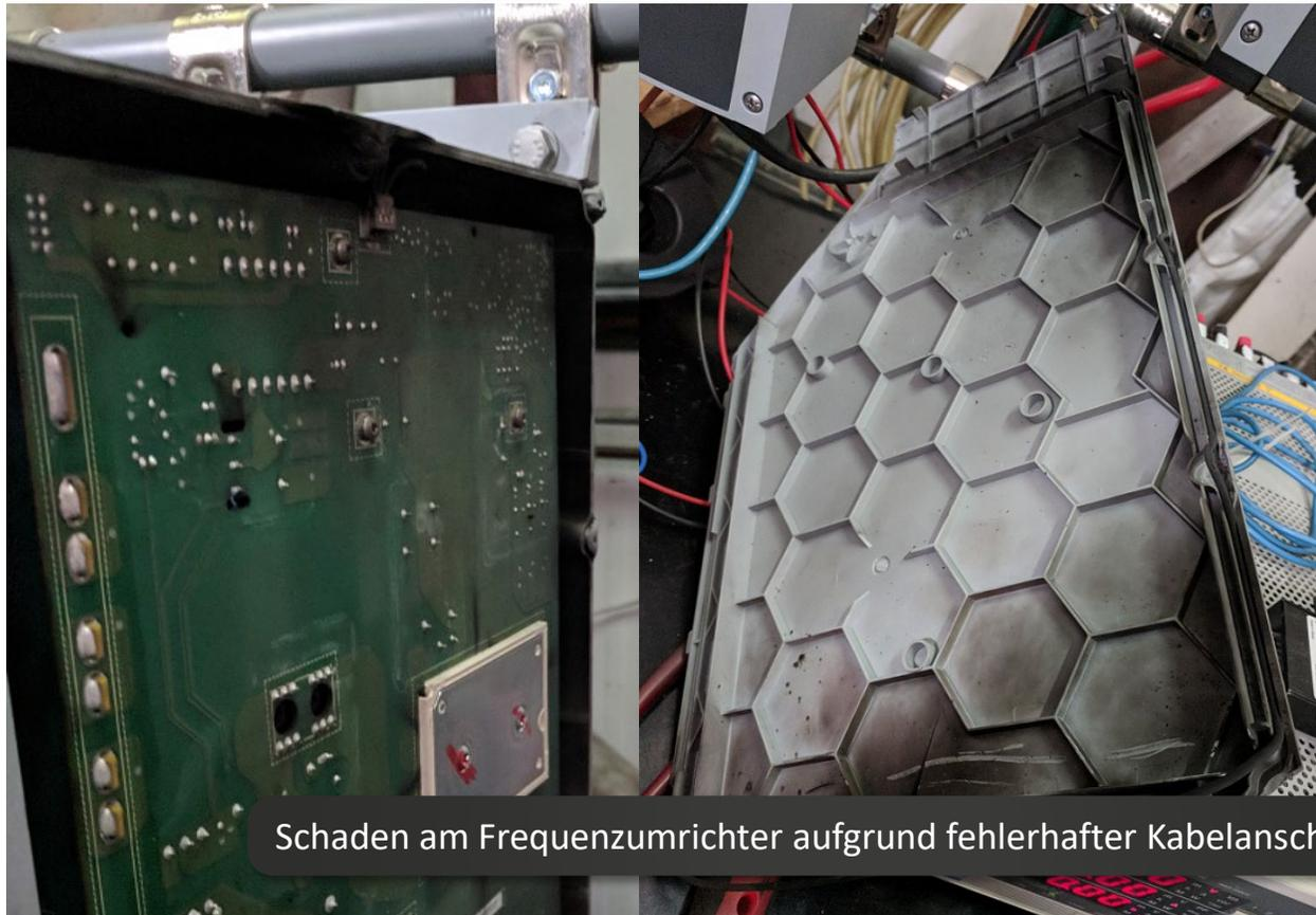
Schaden am Frequenzumrichter aufgrund fehlerhafter Kabelanschlüsse
